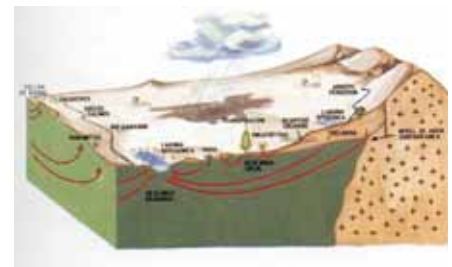
Esquema de F. González Bernáldez sobre los sistemas de flujo del acuífero de Madrid.
